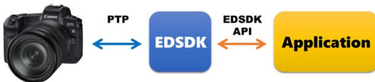
Рисунок 5. Спрощена схема дизайну системи, що включає у себе бібліотеку EDSDK та додаток, що її використовує
