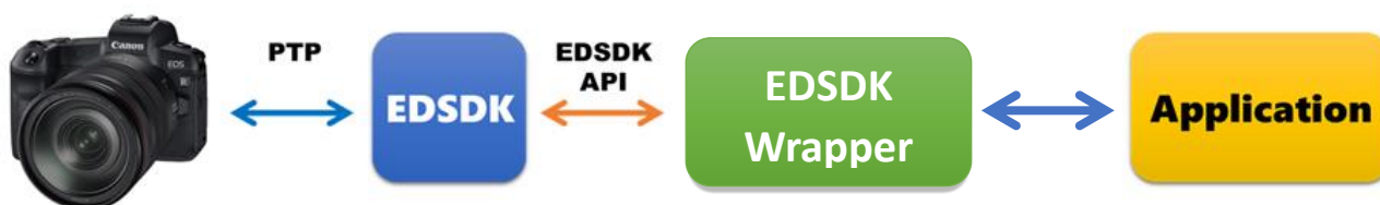
Рисунок 6. Спрощена схема дизайну системи, що включає у себе бібліотеку EDSDK, її обгортку та додаток, що її використовує
