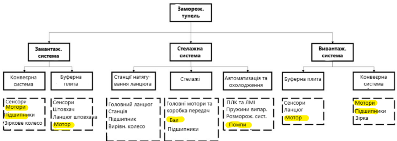
Рисунок 3.1 - Розподіл та ідентифікація критичних компонентів морозильного тунелю ОЧУ
