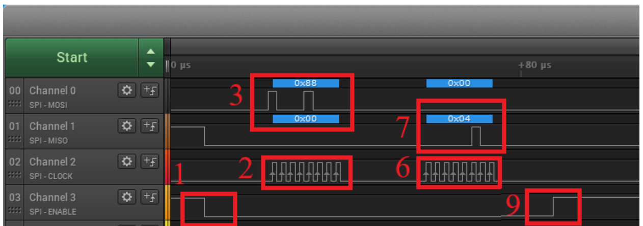
Рисунок 3.6 – Цифровізовані сигнали взаємодії з модулем радіочастотної ідентифікації
