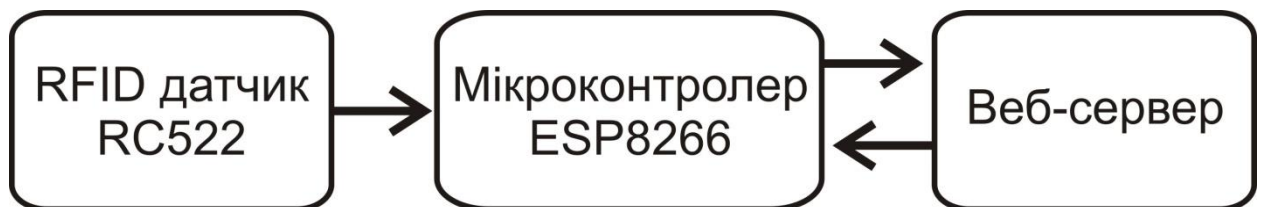
Рисунок 3.2 – Схема зв'язку модулів
