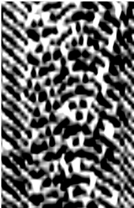
Рис. 1. Скануюча тунельна мікроскопія напівпровідникової нанотрубки. Просторова роздільна здатність 0.06 нм.
