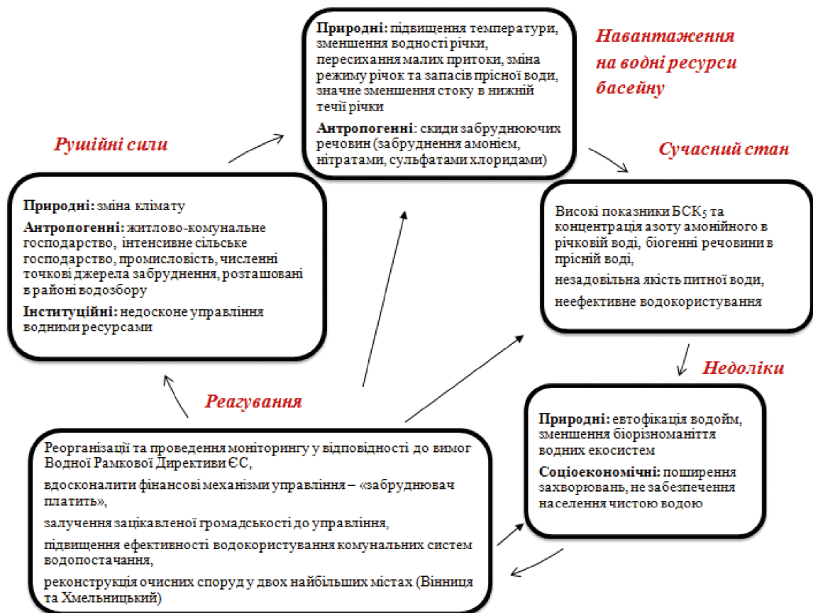
Рис. 6. Загальна система DPSIR для водних ресурсів басейну р. Південний Буг (проілюстрована авторами на основі Mattas, 2014). Fig. 6. A generic DPSIR framework of water resources of the Southern Bug River basin (illustrated by the authors based on the framework of Mattas, 2014).
