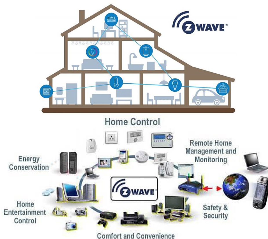
Рисунок 1.10 – Кіберфізична система «розумний дім» на базі технології Z-Wave
