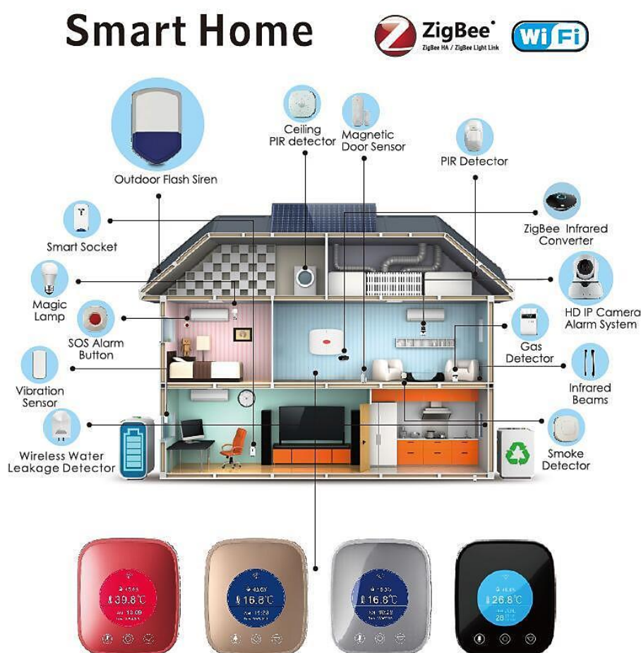
Рисунок 1.9 – Кіберфізична система «розумний дім» на базі технології ZigBee
