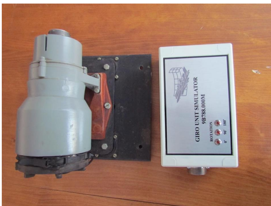
Рис. 4.7. Розроблений імітатор гіровузла та механічний гіроскоп.
