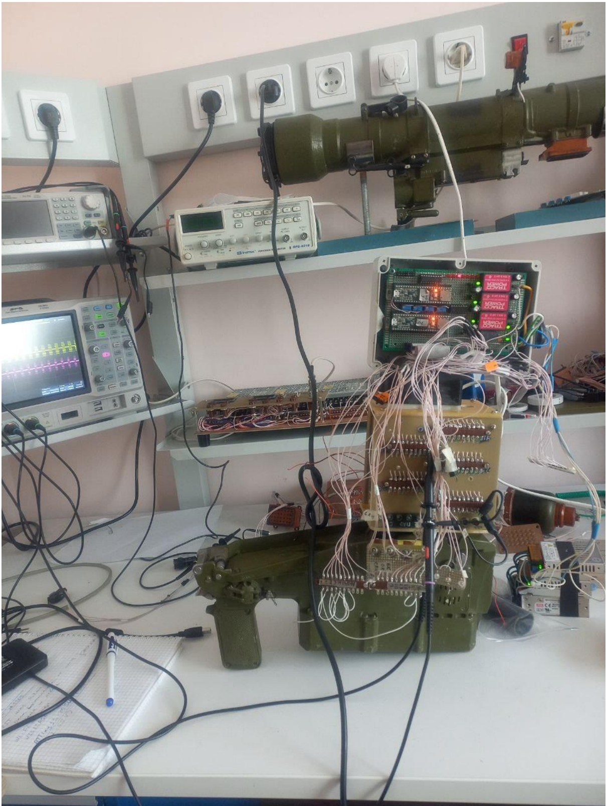
Рис. 4.4. Підключення імітатора гіроскопу (відладочної плати) до пускового механізму.
