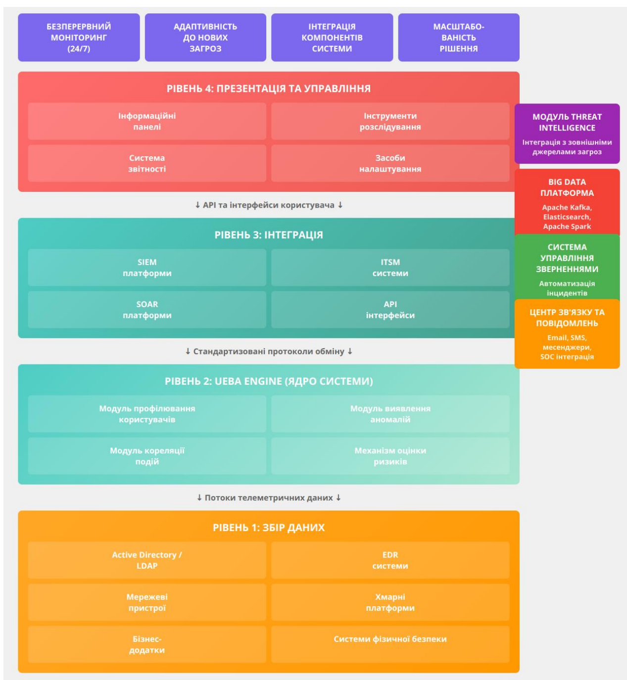
Рисунок В.1. Структура механізму захисту користувачів інформаційної системи від атак соціальної інженерії - Стрілки на рисунку показують напрямки потоків даних та взаємодії між компонентами системи. UEBA Engine це центральний елемент моделі UEBA, що забезпечує аналіз поведінки користувачів та виявлення загроз соціальної інженерії через машинне навчання та кореляцію подій.
