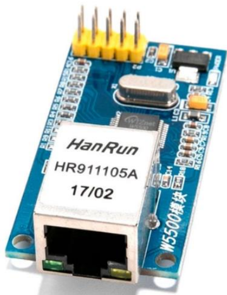
Рисунок 2.2. Зовнішній вигляд та основні характеристики модуля W5500
