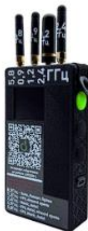
Рисунок 5.5 детектор дронів MDDSR1 "Ксеон-L"
