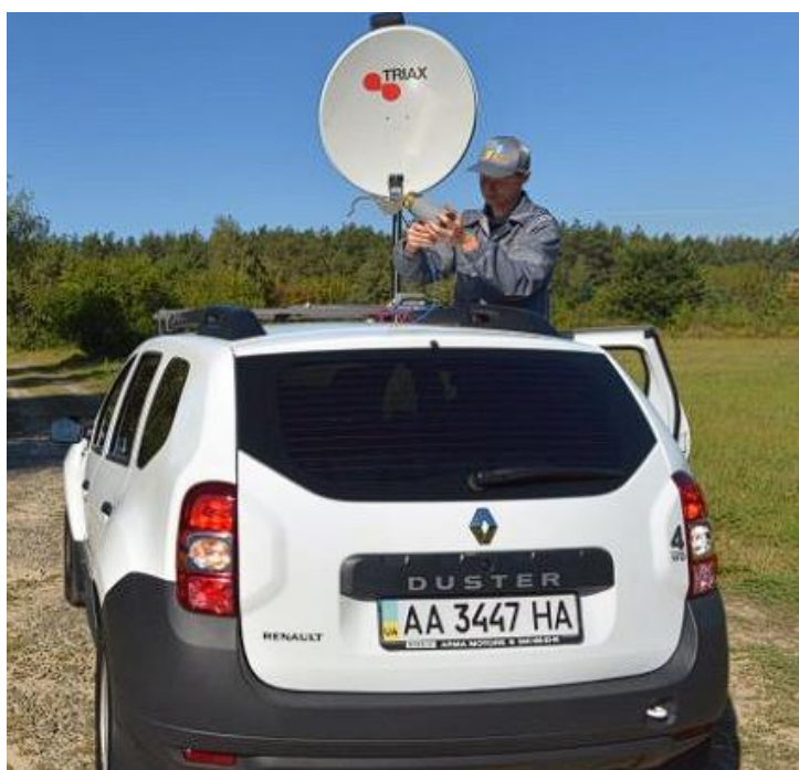
Рисунок 3.3 Фахівець УДЦР проводить радіопеленгацію джерела радіозавад
