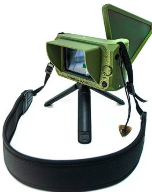
Рисунок 6.6 спектроаналізатор TinySA Ultra
