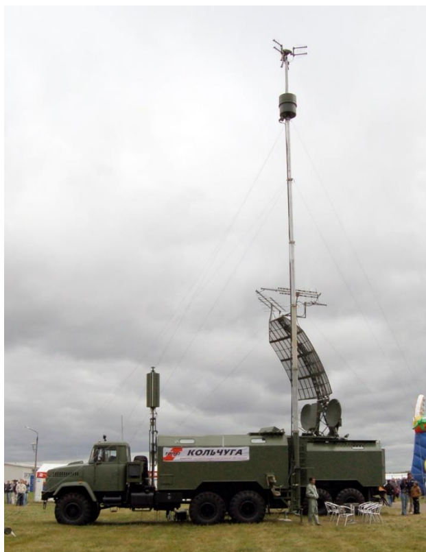
Рисунок 1.1 Система РЕР «Кольчуга»
