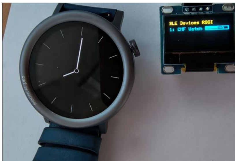
Рисунок 2.12 Тестування працездатності коду , вивід інформації на OLED дисплей
