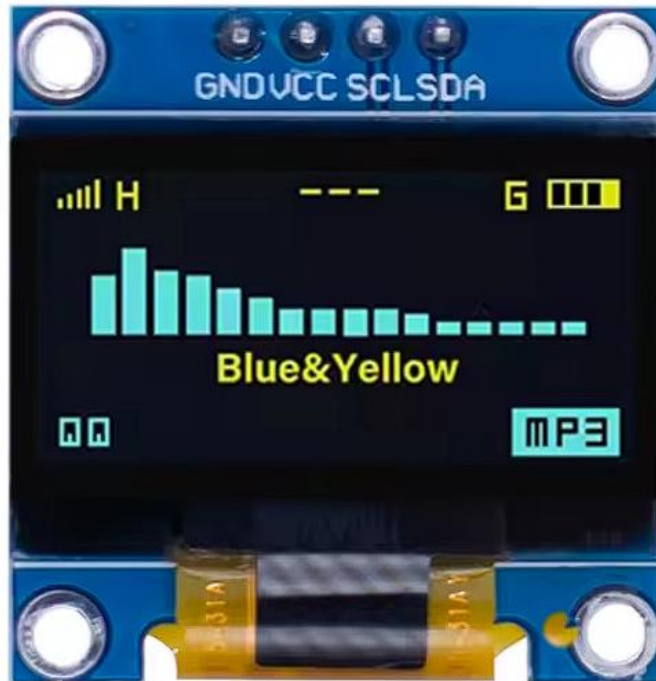
Рисунок 2.5 OLED дисплей SSD1315
