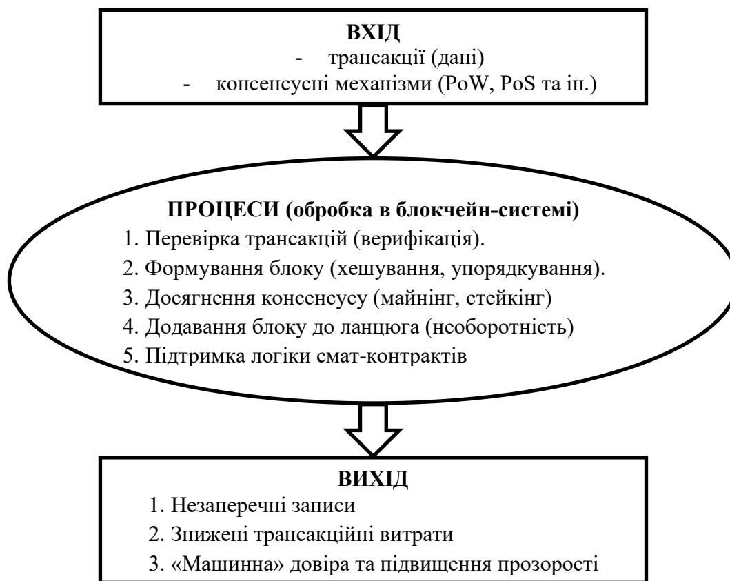
Рис. 1.2. Концептуальна модель блокчейну за принципом «Вхід – Процеси – Вихід»
