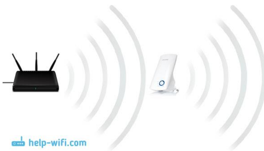
Рисунок 1.3 – Схематичне зображення принципу роботи Wi-Fi повторювача
