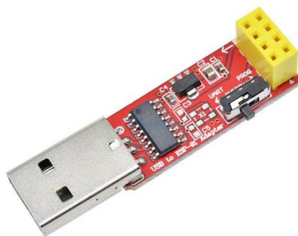
Рисунок 2.3 – USB-перехідник для програмування і налагодження модулів ESP-01 і ESP-01S [9]
