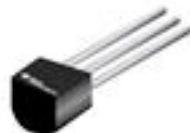
Рисунок 1.7 – Температурний датчик LMT84LP від компанії Texas Instruments
