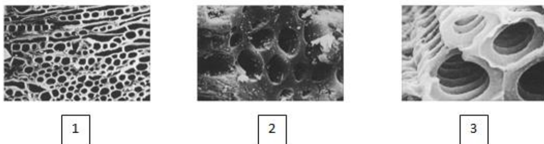
Рис. 1.2. Структура пор активованого вугілля відповідно до вихідних речовин, які бралися за основу: 1 – деревина, 2 – кам'яне вугілля, 3 – кокосове вугілля.
