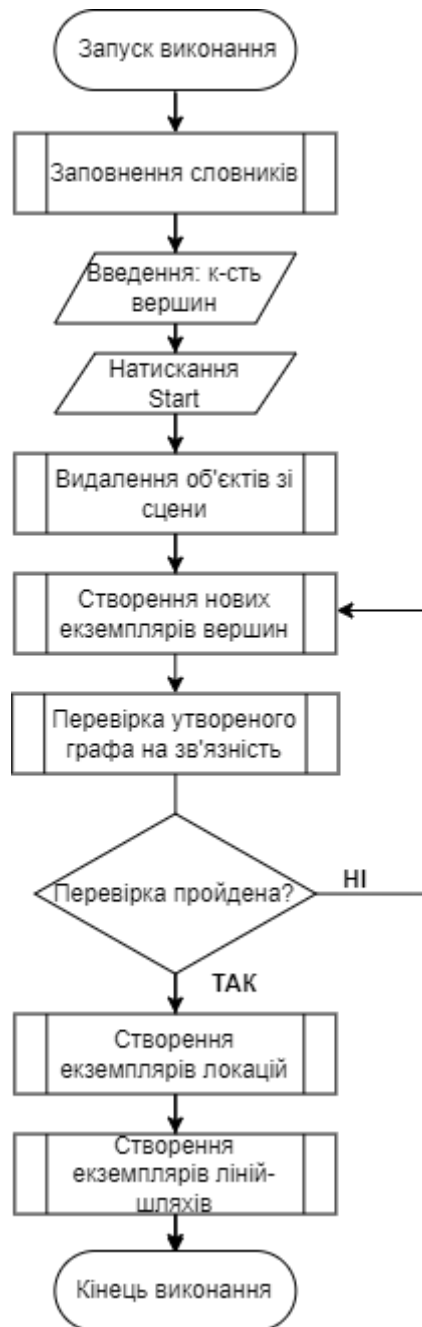
Рисунок 3.10.2 – блок-схема алгоритму виконання програми
