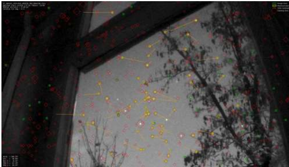
Рис. 4. Приклад інтерфейсу програмного забезпечення RMS для автоматичної ідентифікації опорних зір у полі зору камери, необхідних для астрометричної прив'язки метеорних траєкторій. Зображення отримано в тестовому режимі
