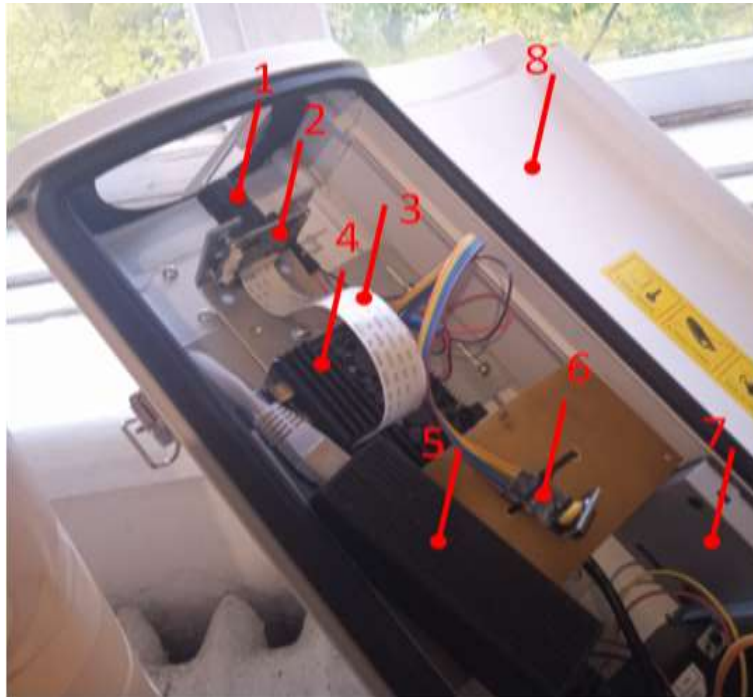
Рис. 1. Конструкція RSM-відеокамери для спостережень метеорів: 1 – об'єктив; 2 – HD-камера із сенсором Sony STARVIS IMX462; 3 – 15-контактний FPC-шлейф; 4 – мікрокомп'ютер Raspberry Pi 4 Model B (8 ГБ ОЗП); 5 – Gigabit PoE Splitter; 6 – модуль реального часу DS3231; 7 – система охолодження й опалення внутрішнього простору захисного бокса; 8 – захисний кожух (бокс) для камер відеоспостережень
