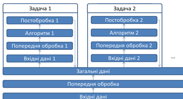
Рис. 3. Схематична архітектура пакетно-алгоритмічного підходу
