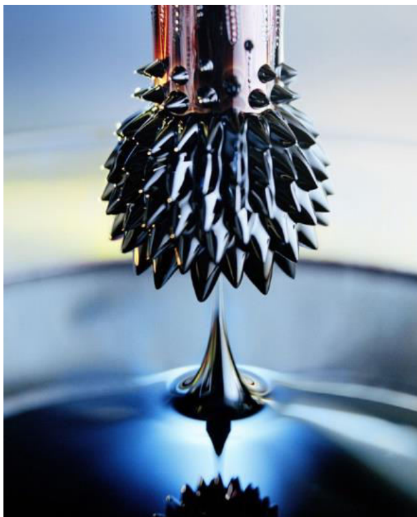
Рис. 1.2. Ефекти, які з'являються на вільній поверхні ферофлюїду під дією зовнішнього магнітного поля внаслідок поєднання плинності та магнетизму системи [55]
