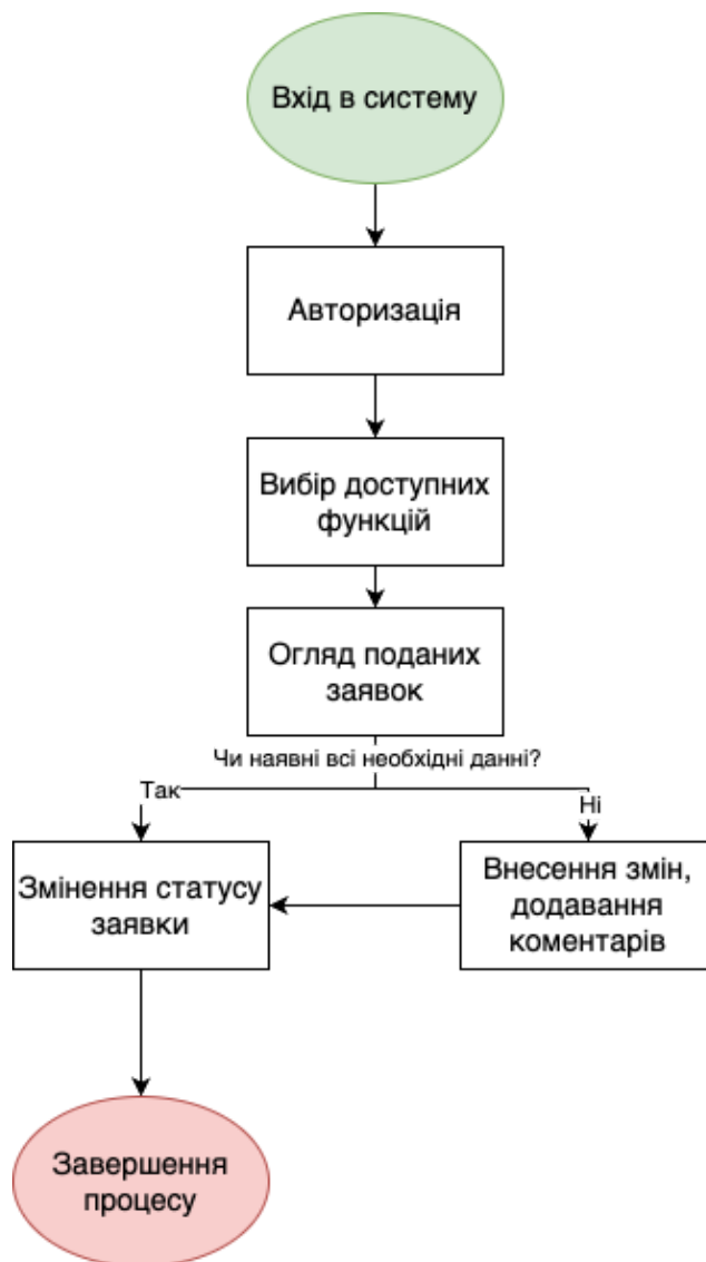
Рис. 2.6 Блок-схема роботи веб-сервісу для державних службовців
