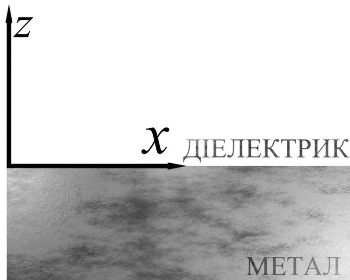
Рис. 1.2 Геометрія розповсюдження ППП вздовж одинарною межею середовища між металом та діелектриком
