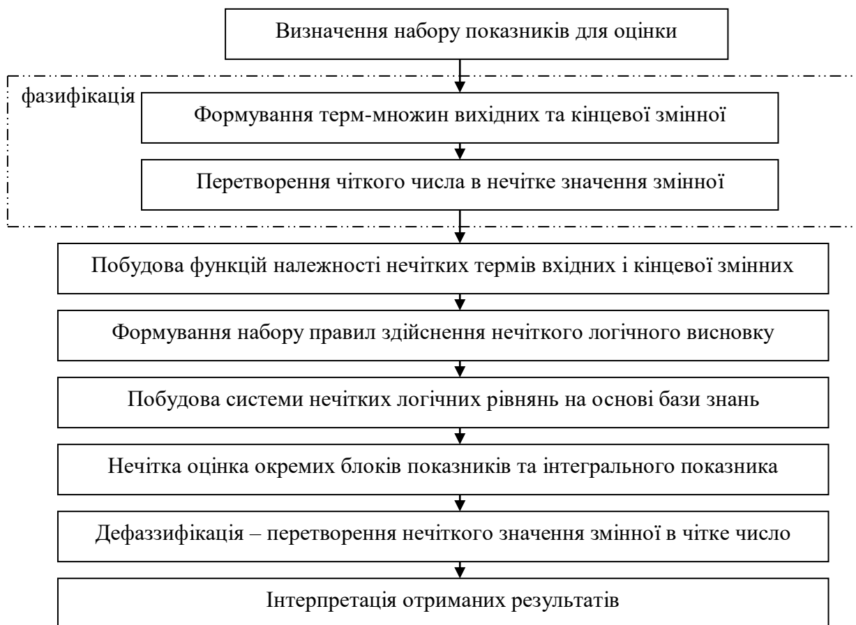
Рис. 1.3. Схема процесу розрахунку на основі нечітких понять
