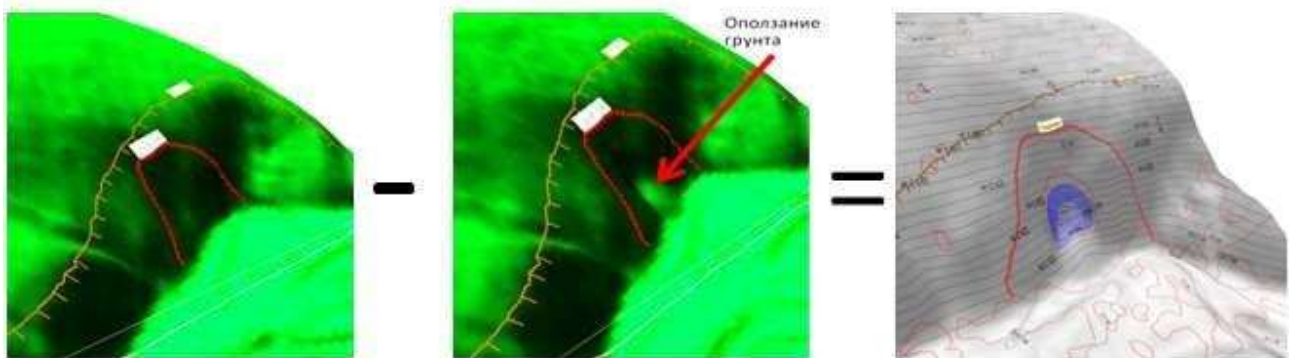
Рис. 11. Фрагменти різночасових статичних моделей рельєфу (два сусідні роки) (горизонталі синього кольору показують негативну динаміку, червоні позитивну – переріз горизонталей 0.1 м.) (NASA. Landsat Science, 2023)
