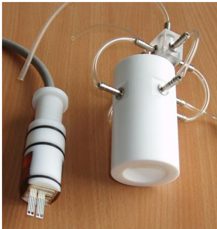
Рис.8. Фото герметичної тефлонової камери з хеморезистивними мікроелектродами в утримувачі.
