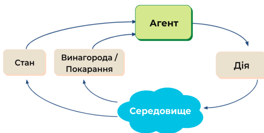
Рисунок 2.8 — Принцип роботи алгоритму навчання з підкріпленням
