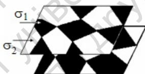
Рис. 4.29. Двофазне дуальне середовище: зверху – "основне" середовище, знизу – дуальне до нього. Областям із провідністю \sigma_1 ( \sigma_2 ) в "основному" середовищі відповідають області \sigma_2 ( \sigma_1 ) у дуальному
