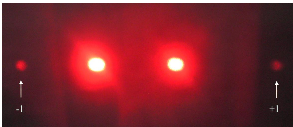
Рис. 3.10. Фотографія відновленого зображення голограми плоского хвильового фронту, записаної в плівці ФПК на основі ОАГЕ + 5% К1 + 1% SQ. \omega = 450 \text{ мм}^{-1} , \lambda = 650 \text{ нм} , I = (I_1 + I_2) = 10^2 \text{ Вт/м}^2 , співвідношення інтенсивностей опорного та об'єктного променів 1:1. Відповідні порядки дифракції позначені стрілками. \eta = 0,35 \% .
