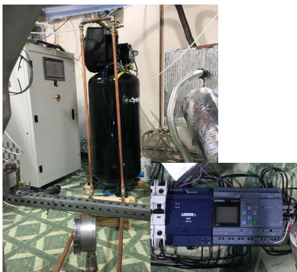
Рис. 3.13 – Система рециркуляції продуктів плазмохімічної реакції з системою управління
