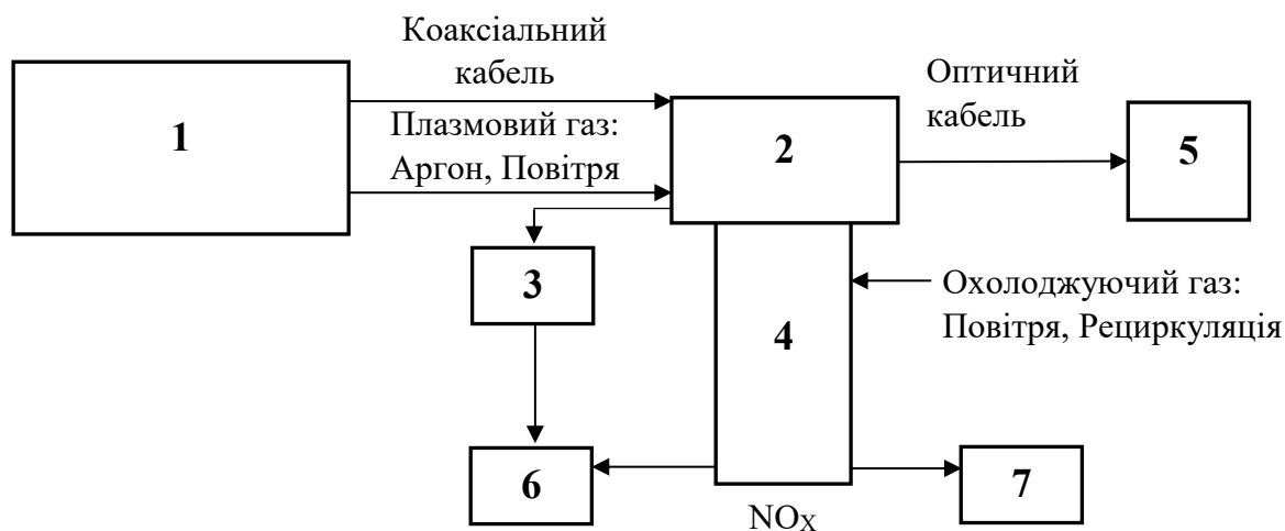
Рис. 3.1 – Блок-схема експериментальної установки для отримання \text{NO}_x :
