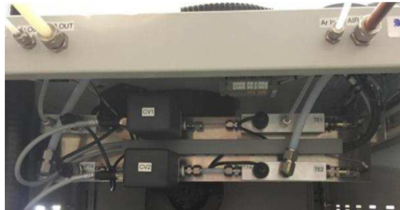
Рис. 3.7 – Зовнішній вигляд системи регулювання плазмоутворювальними газами
