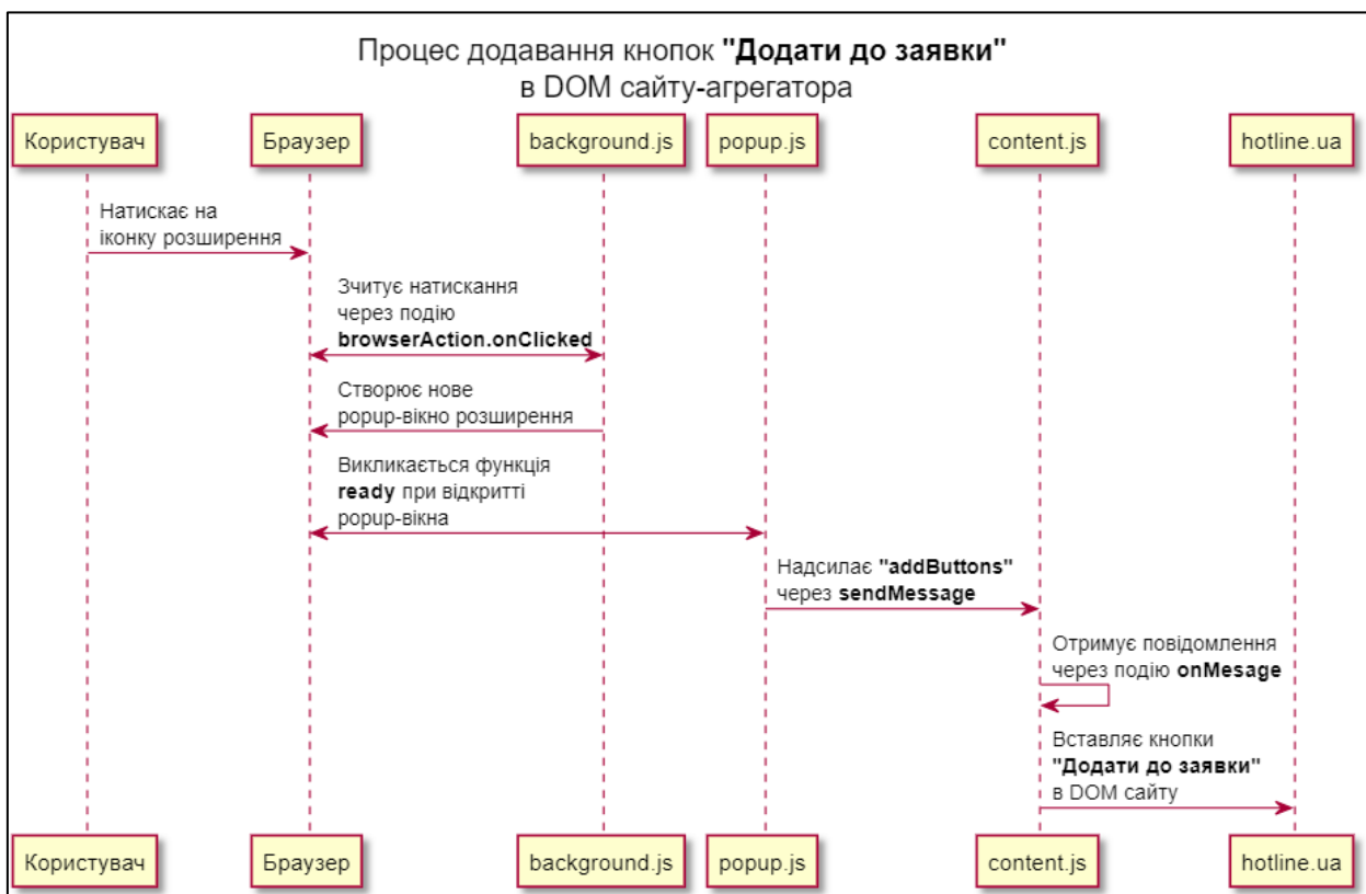
Рис. 9 Процес додавання кнопок в DOM сайту-агрегатора «hotline.ua»
