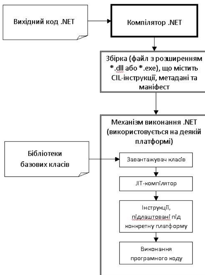
Рисунок 1.2 – Взаємодія між вихідним кодом .NET, компілятором .NET і механізмом виконання .NET
