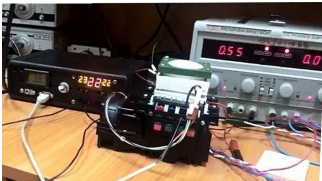
Рис.14 – Лабораторна установка для дослідження температури гарячого спаю
