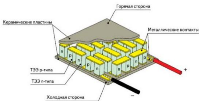
Рис.3 – Структура модуля Пельтьє
