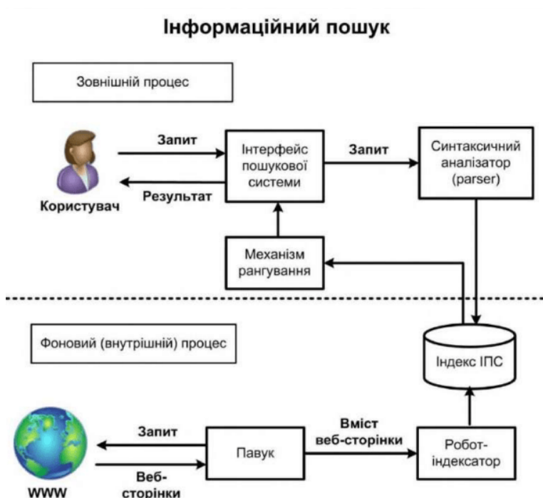
Рис. 1. Принцип роботи пошукового робота, який використовується пошуковою системою для виявлення нових сторінок в інтернеті
