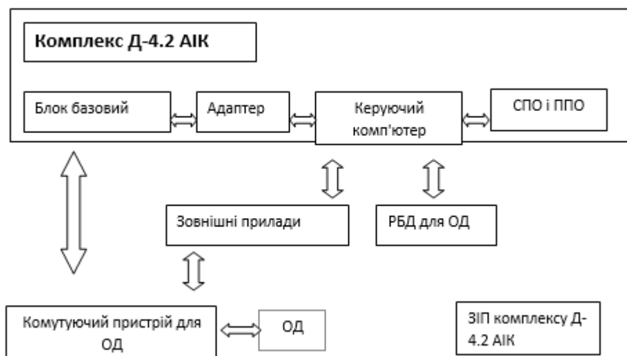
Рисунок 2.1 – Склад комплексу Д-4.2 АІК
