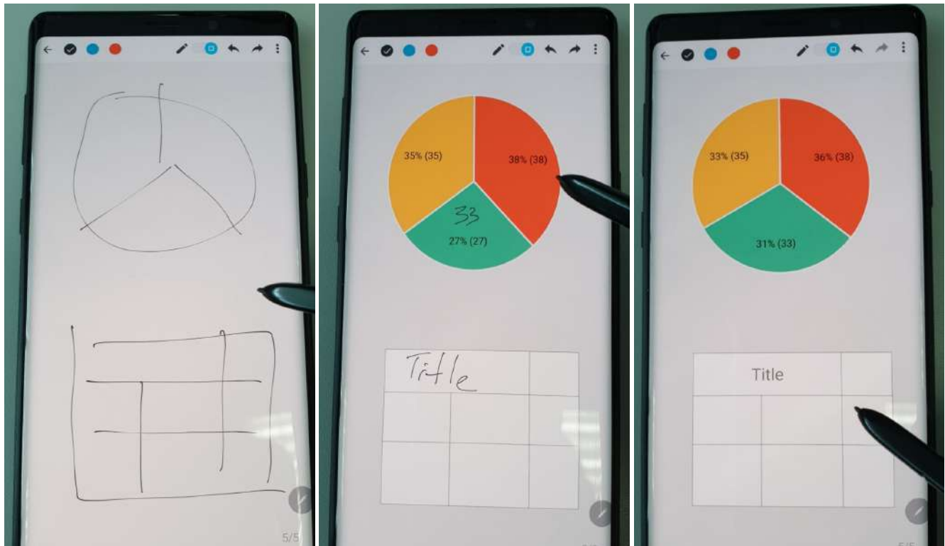
(а) Користувач малює елементи документа за допомогою стилуса (б) Кругова діаграма та таблиця розпізнаються та перетворюються на відповідні елементи, користувач додає рукописний текст (в) Рукописний текст розпізнається та перетворюється на друкований текст застосовується до відповідних елементів документа
