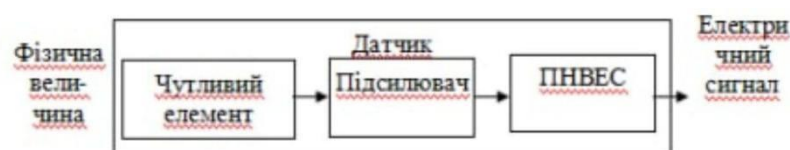
Рисунок 2.5 - Будова простого датчика
