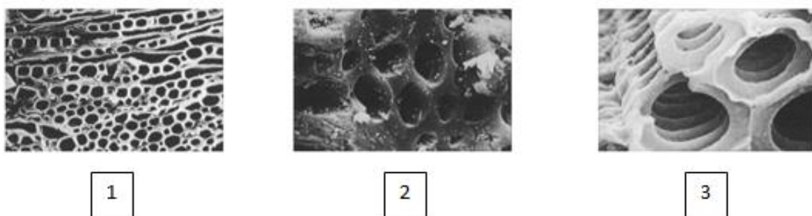
Рис. 1.6. Структури пор АВ на основі різних вихідних матеріалів: 1 – деревини, 2 – кам'яного вугілля, 3 – кокосового вугілля.
