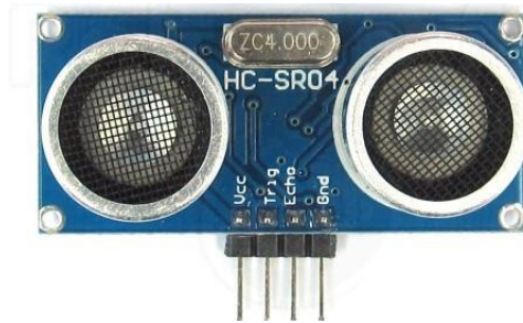
Рисунок 12. Ультразвуковий датчик відстані HC-SR04
