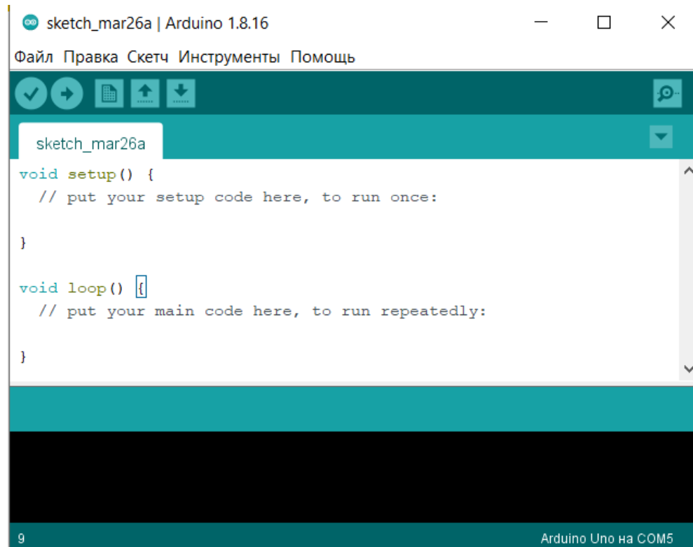
Рисунок 20. Стандартний скетч в Arduino IDE
