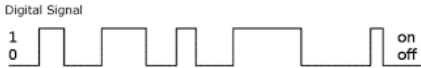
Рисунок 9. Приклад цифрового ШІМ сигналу з n -частин підімпульсів
