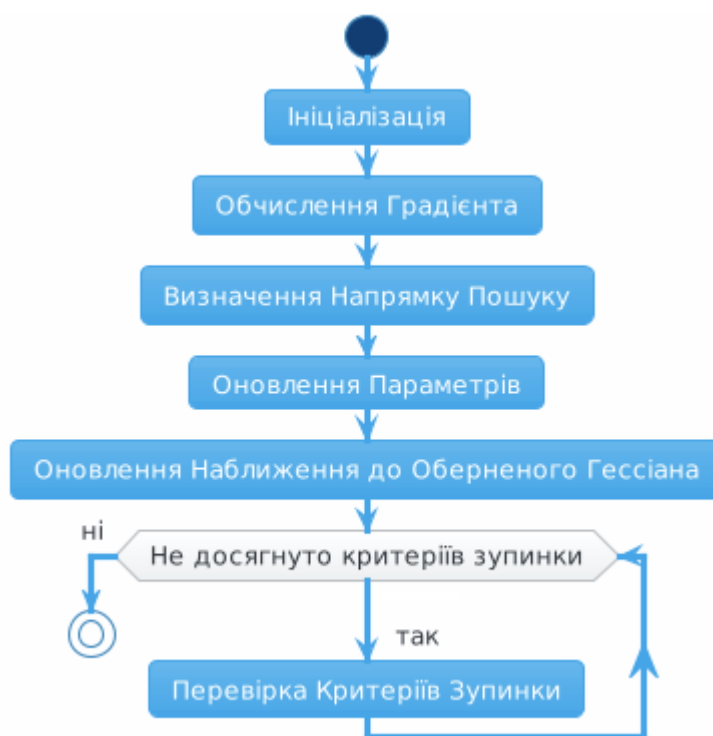
Рисунок 2.6 – Схема алгоритму БФГШ
