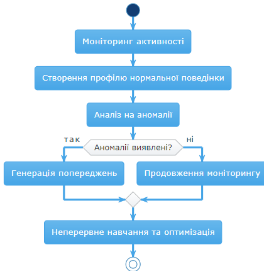
Рисунок 2.4 – Алгоритм методу поведінкового аналізу
