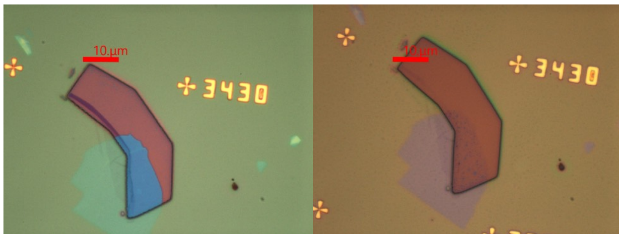
Рисунок 12: Порівняння зразка до і після травлення.
