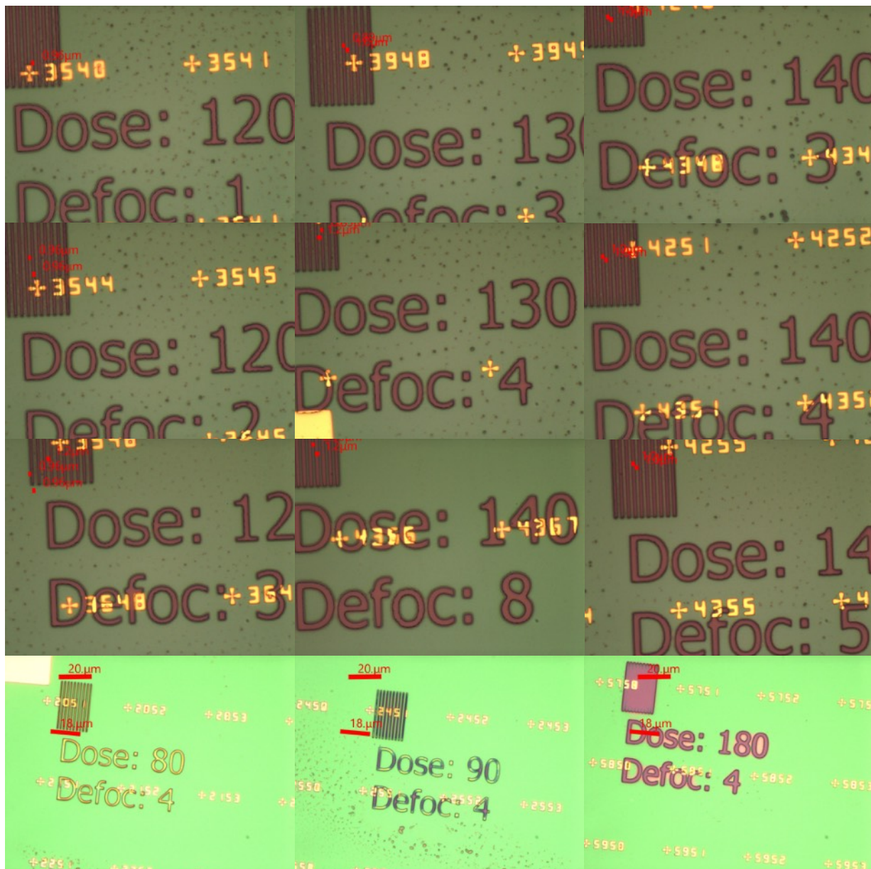
Рисунок 9. Зображення оптичного мікроскопа, що демонструють вплив дози та дефокусу на якість експозиції
