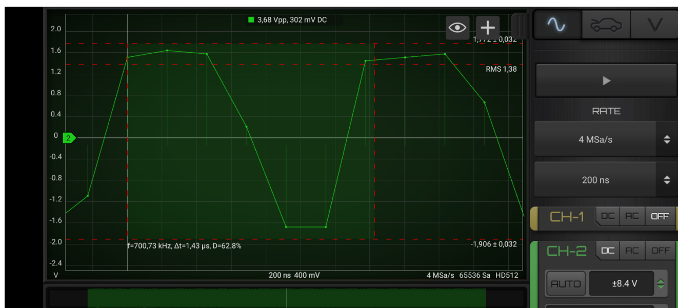
Рисунок - 2.16 ШІМ – сигнал частотою 700 кГц
