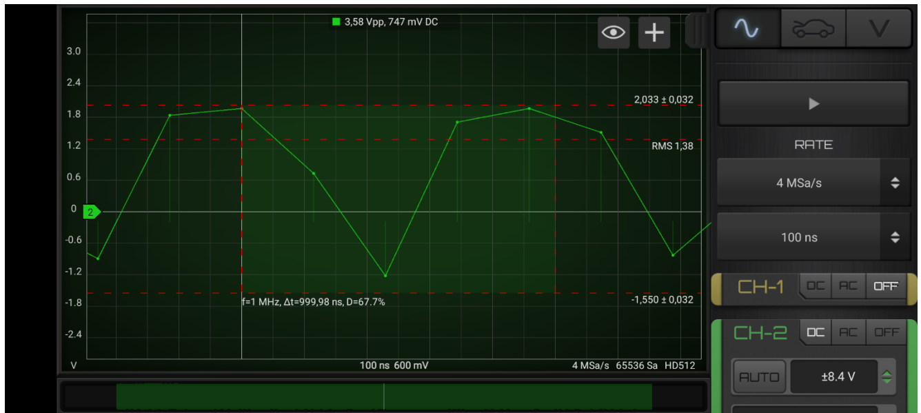
Рисунок - 2.17 ШІМ – сигнал частотою 1 МГц
