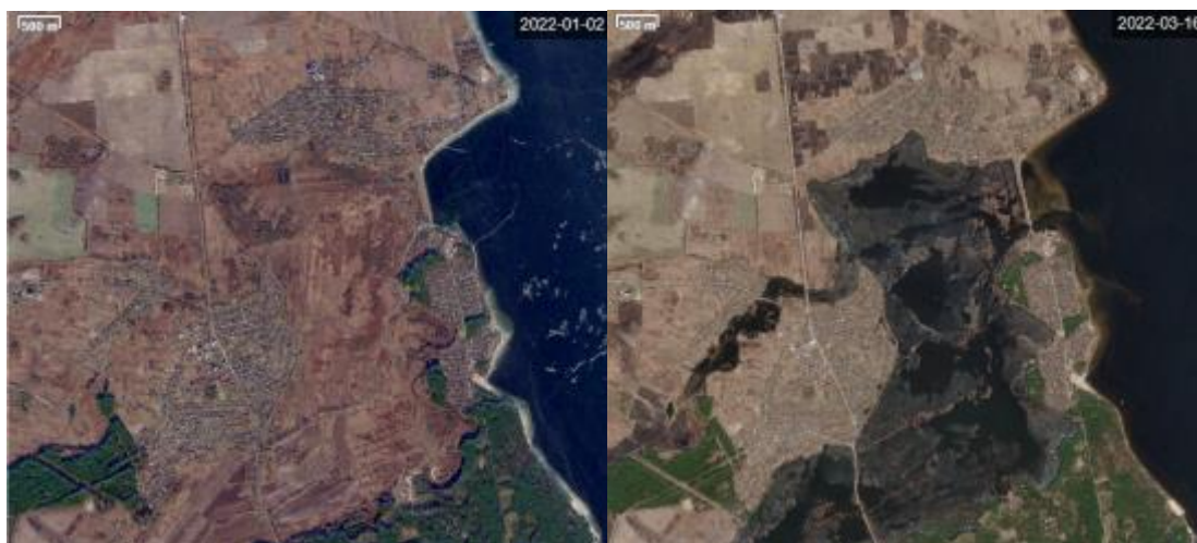
Рис. 2.1. Космічні знімки заповни р. Ірпін до (02.01.2022) та після (16.03.2022) підриву греблі в Козаровичах
