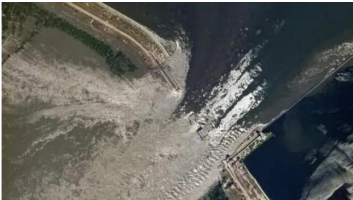
Рис. 2.4. Космічний знімок зруйнованого створу та відірваної частини греблі Каховської ГЕС (червень 2023 р.)
