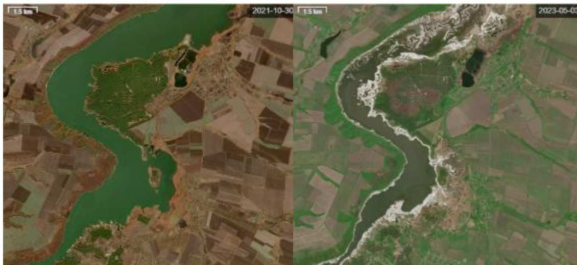
Рис. 2.2. Космічні знімки акваторії Оскільського водосховища до та після руйнування греблі в березні 2022 р.
