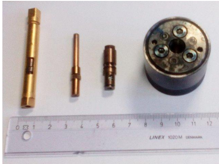
Рис. 32. Фотографії комірок високого тиску для магнітних та спектроскопічних досліджень.
