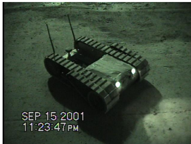
Рисунок 1.5 – Гусеничний наземний робот PackBot, який використовувався для пошуково-рятувальних задач [11]
