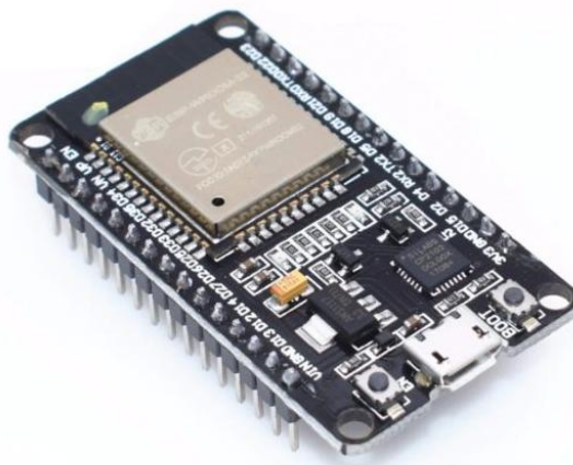
Рисунок 2.4 – Плата розробника LuaNode 32 на базі модуля ESP-WROOM-32
