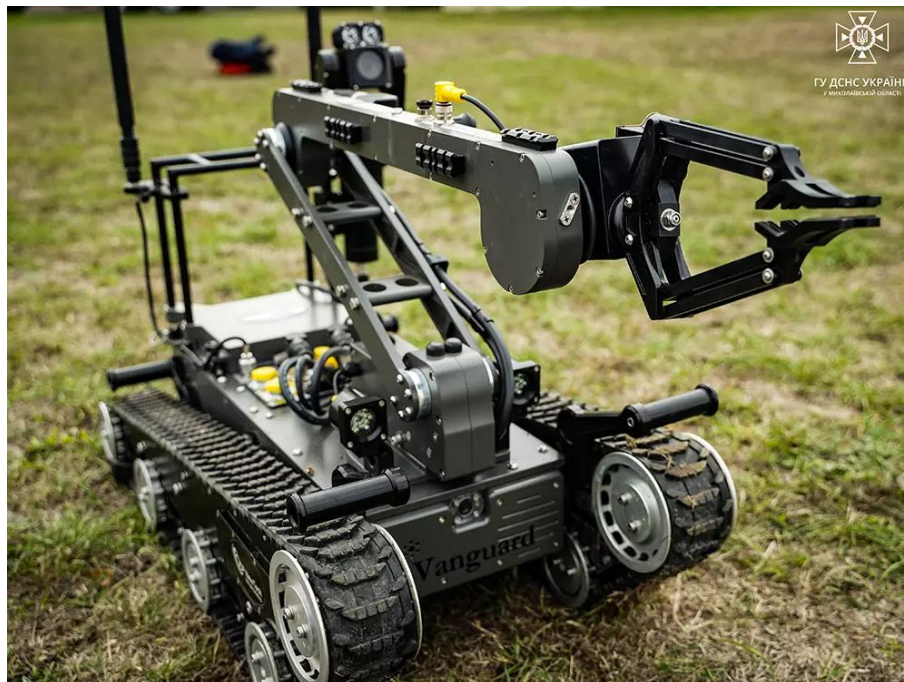
Рисунок 1.4 – Роботизований комплекс DIGITAL VANGUARD-S для розмінування, переданий підрозділам ДСНС України [10]
