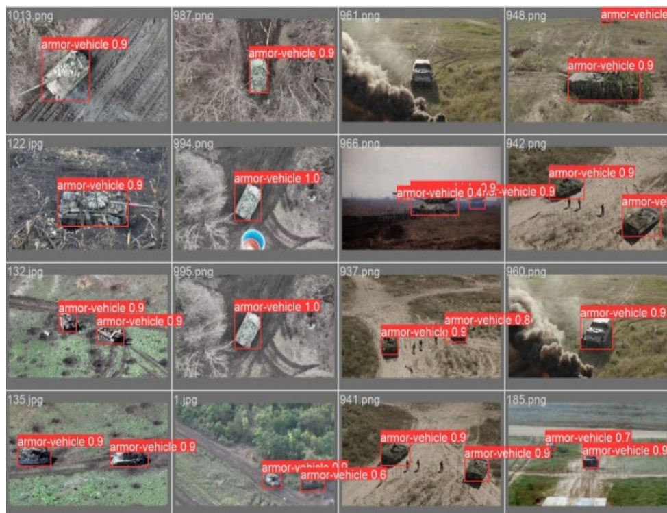
Рисунок 3.20 – Результат аналізу фоторяду за допомогою навченого ШІ YOLO (власна розробка)
