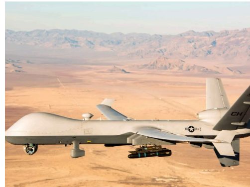
Рисунок 3.17 – Військовий БПЛА MQ-9 Reaper, оснащений камерою для збору інформації та підвісним арсеналом для завдання ударів по ворожим цілям [77].
