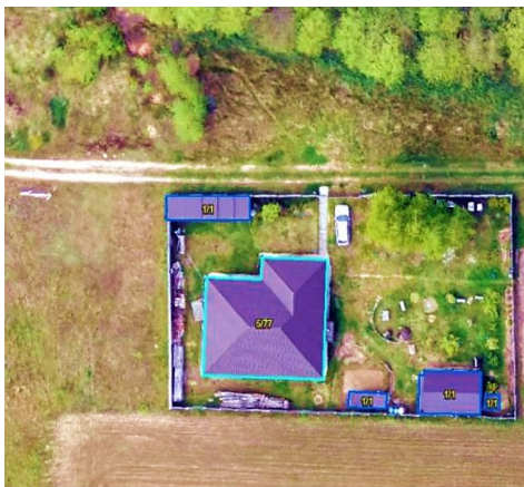
Рисунок 4.36 – Процес векторизації ортофотоплану
