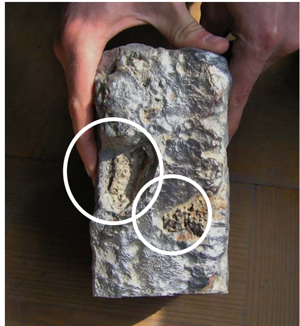
Фото 2, 3. Сторонні включення гірської породи (відмічені колами білого кольору), що спостерігаються як на поверхні штоку (фото 3), так і всередині (фото 2)
