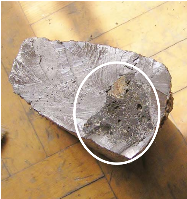
Фото 2, 3. Сторонні включення гірської породи (відмічені колами білого кольору), що спостерігаються як на поверхні штоку (фото 3), так і всередині (фото 2)
