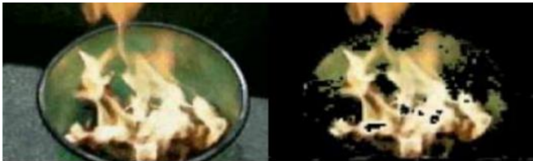
Рисунок 1.13. Зображення полум'я до та після обробки нейронною мережею
