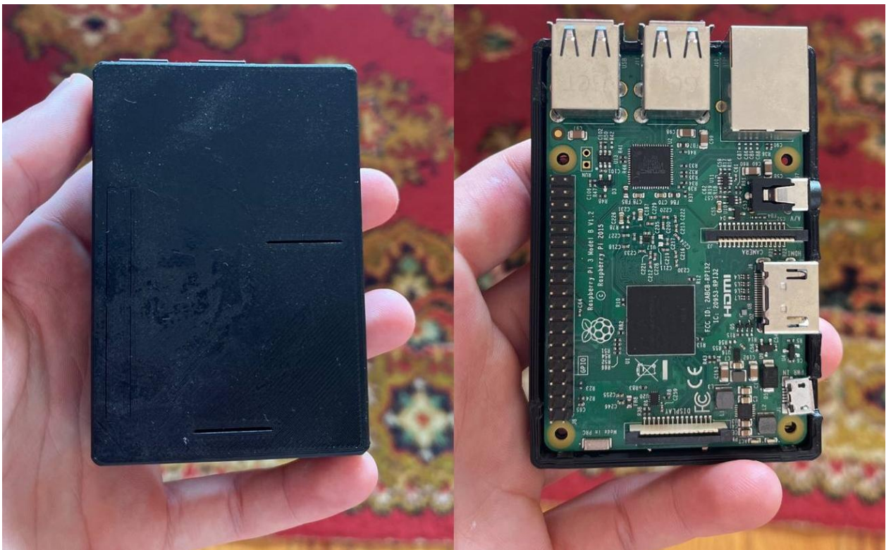
Рисунок 3.3 – Фото пристрою сконструйованого на базі Raspberry Pi 3 model B
