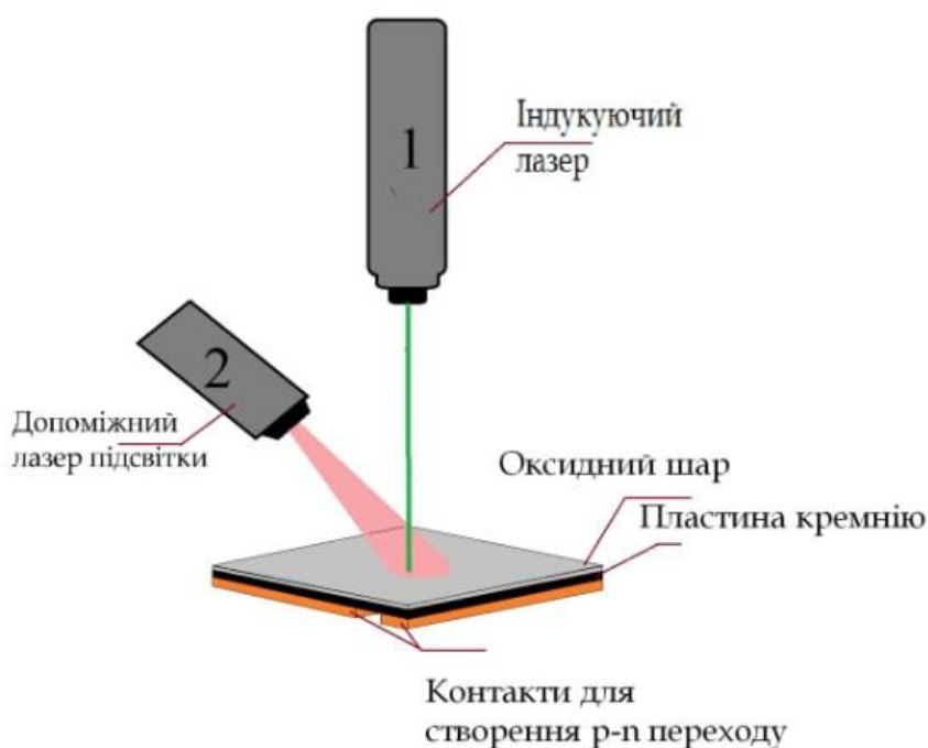
Рис. 2.3 - Схематичне зображення експериментальної установки для отримання ФЕВ ділянки освітлення двома лазерами
