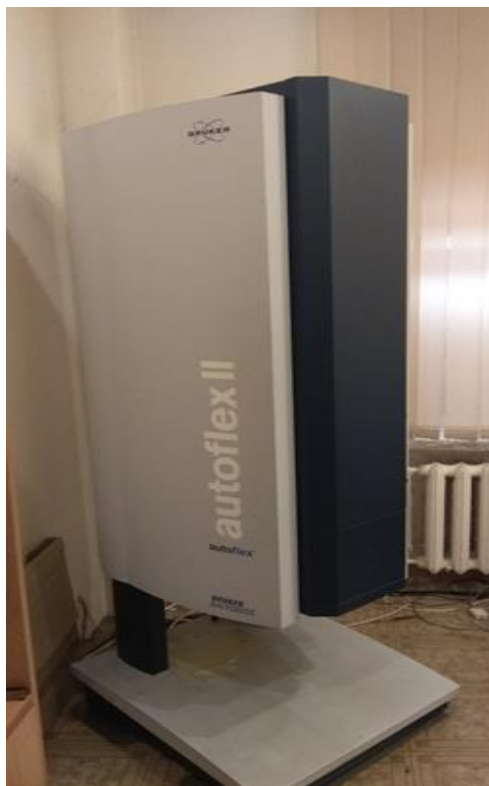
Рис. 2.2. Зображення приладу MALDI-TOF мас-спектрометра
