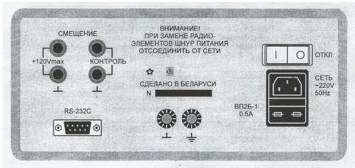
Рисунок 2.4 — Задняя панель прилада E7-20.
