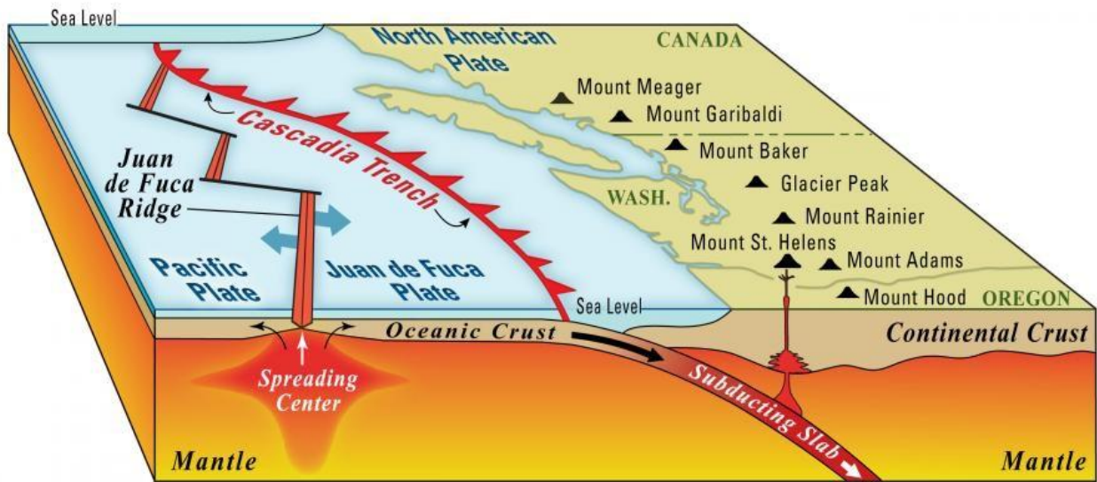
Рисунок 4.14 — Субдукція плити Хуан-де-Фука під Північноамериканську плиту вздовж Каскадної западини є відповідальним за вулканізм Каскадного хребта, Дзурісін та ін., 2013.
